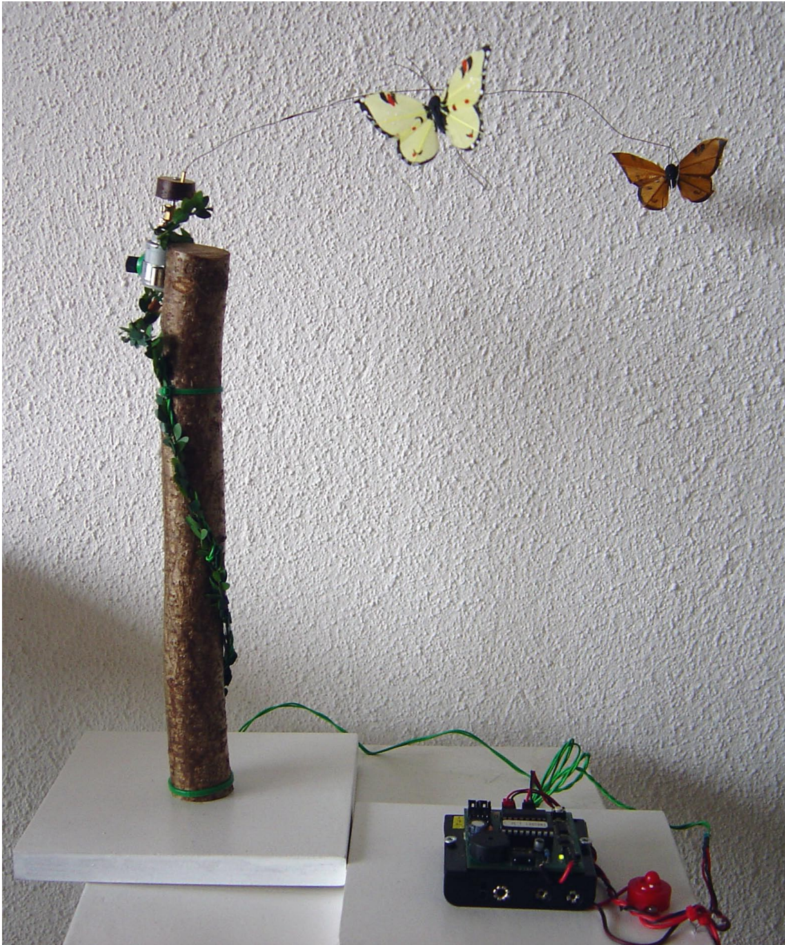
Le moteur peut être commandé par un microcontrôleur pour créer des vols aléatoires
